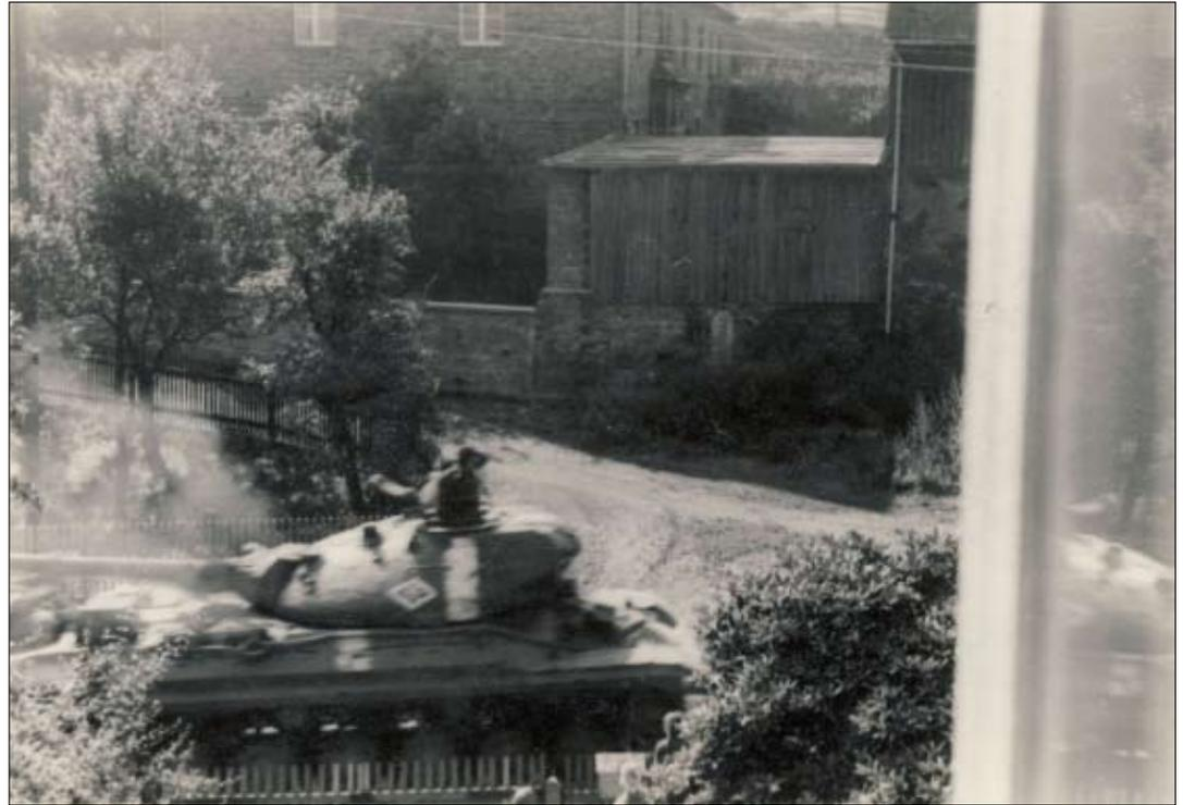
Es zeigt einen sowjetischen Kampfpanzer T-10 mit gegen die Fahrtrichtung gedrehtem Geschütz. Der 52 Tonnen schwere T-10 für vier Mann Besatzung hatte 700 PS, einen stark gepanzerten Turm mit einer runden, geschossabweisenden Kuppelform und wurde seit 1952 für die russische Armee produziert.
